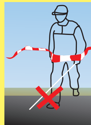
Nedostatečně zabezpečený výkop
